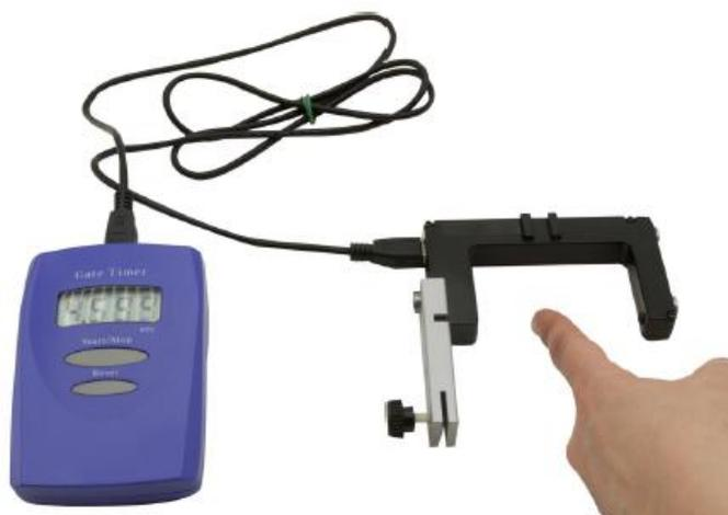
**Attention !** : n'interceptez pas le faisceau optique de la fourche photoélectrique avec votre doigt durant n'importe quelle opération, si cela se produit, réinitialisez le chronomètre en appuyant sur le bouton RESET.
