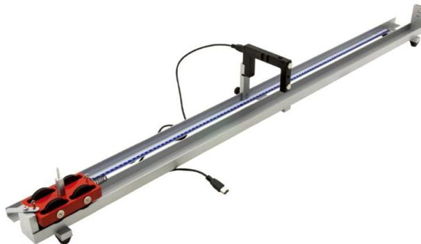
Utilisez le câble pour connecter le chronomètre au port B de la fourche photoélectrique et, immédiatement après, lancez le chariot depuis l'extrémité gauche du rail. Le chronomètre commence à compter le temps à partir duquel il passe devant la fourche photoélectrique.
