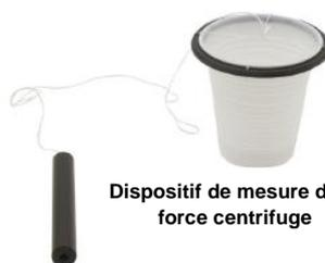
Dispositif de mesure de la force centrifuge
