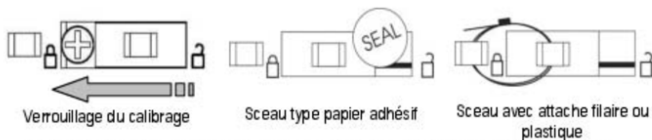
Figure 4-1. Verrouillage et apposition de sceau pour le commutateur de verrouillage du calibration.
