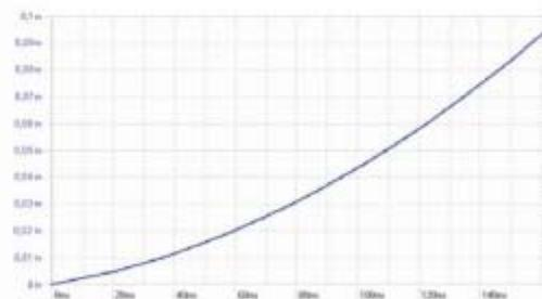
Fig. 2 : Trajet de chute en fonction du temps
