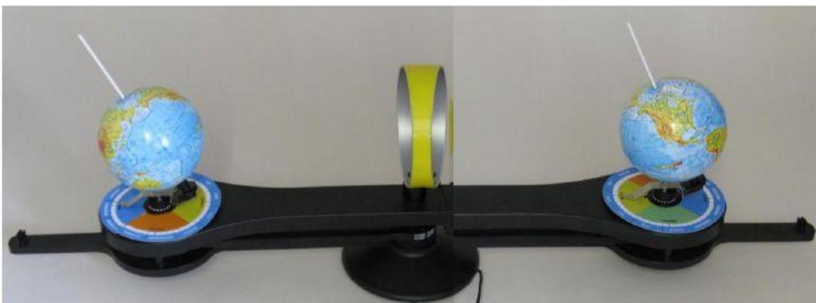
*Fig. 5 L'axe de la Terre qui pointe « en haut et à gauche » crée un été dans l'hémisphère nord (à droite) et, six mois plus tard, sur le côté opposé du Soleil, l'hiver (à gauche). La saison et la date sont indiquées par la position du pointeur sur le disque de dates.*
