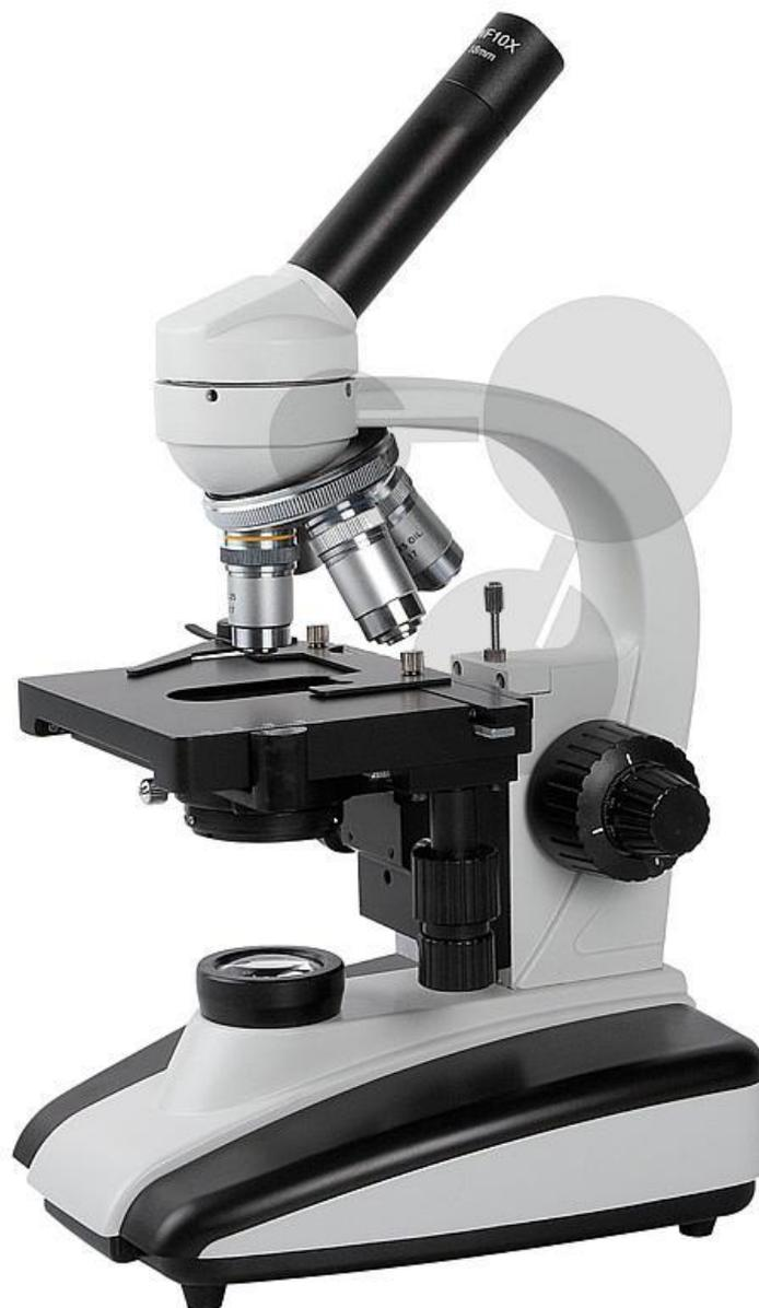
**Caractéristique d'un microscope :** L'oculaire fournit un agrandissement supplémentaire de l'image produite par la lentille de l'objectif. Un grossissement de 600 obtenu avec un objectif de 60 et un oculaire de 10 donne plus de détails qu'un grossissement de 600 combinant un objectif de 40 avec un oculaire de 15.
