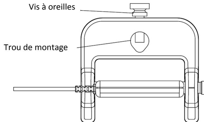
**Figure 2 : Vue du haut du stroboscope**
