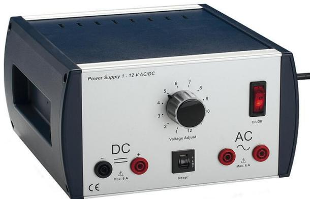
Cette alimentation délivre une tension de 1 à 12 V AC et DC et un courant allant jusqu'à 6A. La tension peut être sélectionnée par incréments de 1V.
