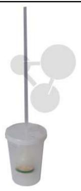
**Remarques préalable :** Les membranes biologiques sont semi-perméables, c'est-à-dire uniquement adaptées à certaines matières. La membrane utilisée dans notre osmomètre n'est pas une biomembrane au sens littéral du terme. Cependant elle présente des propriétés semi-perméables similaires. Le niveau de perméabilité varie en fonction des propriétés de la substance analysée, en particulier la taille des molécules.
