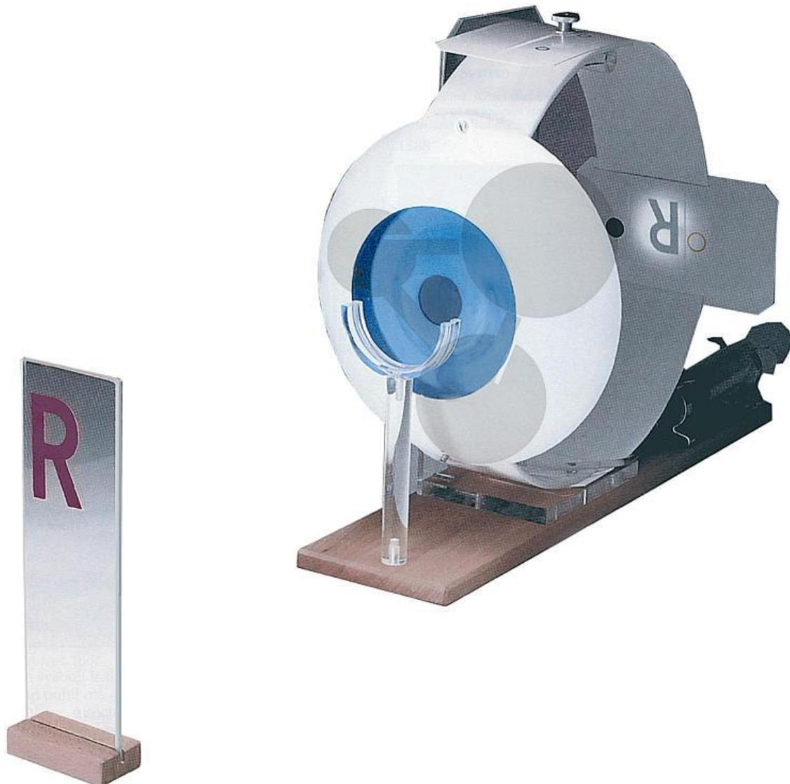
Ce modèle est un modèle classique de démonstration qui simule le fonctionnement optique de l'oeil avec un cristallin à focale variable et les divers défauts qui peuvent toucher l'oeil (myopie, hypermétropie, presbytie).
