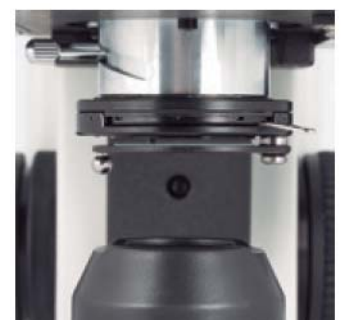
Fokussierbarer 1.25 N.A. Abbe-Kondensor
