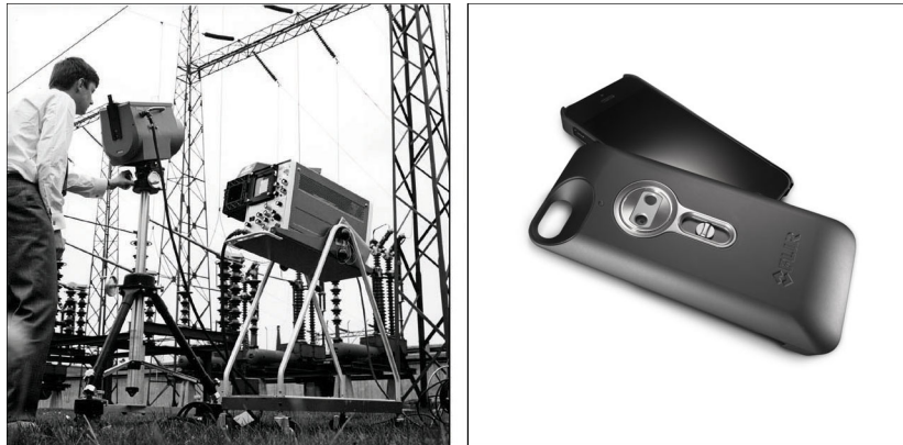
Abbildung 13.2 LINKS: Modell 661 der Thermovision aus dem Jahr 1969. Die Kamera wog ca. 25 kg, das Oszilloskop 20 kg und das Stativ 15 kg. Für den Betrieb wurden darüber hinaus ein 220-Volt-Wechselstromgenerator und ein 10-Liter-Gefäß mit flüssigem Stickstoff benötigt. Links neben dem Oszilloskop ist der Polaroid-Aufsatz (6 kg) zu erkennen. RECHTS: Die FLIR One, die im Januar 2014 auf den Markt gebracht wurde, ist ein aufsetzbares Zubehör, mit dem iPhones Wärmebilder aufnehmen können. Gewicht: 90 g.
