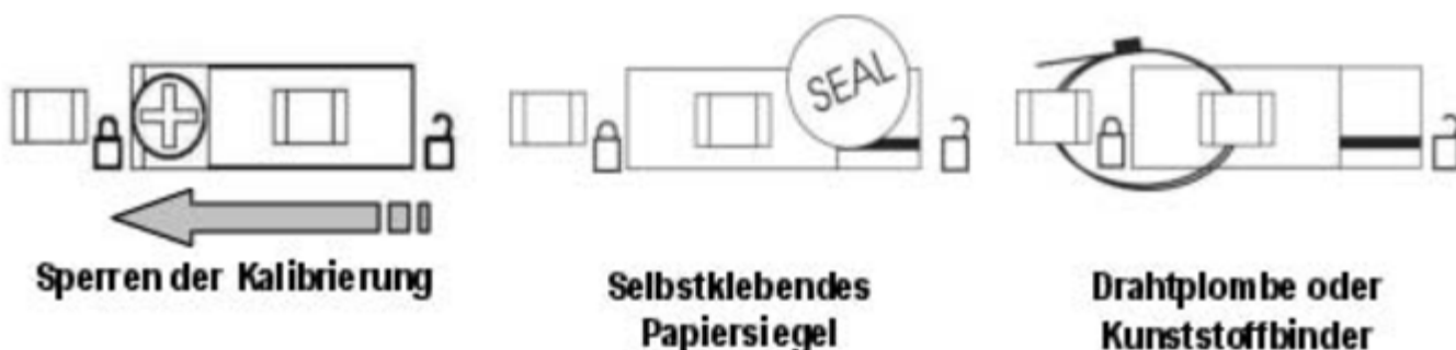
Abbildung 4-1. Sperren und Versiegeln des Kalibrierungssperreschalters
