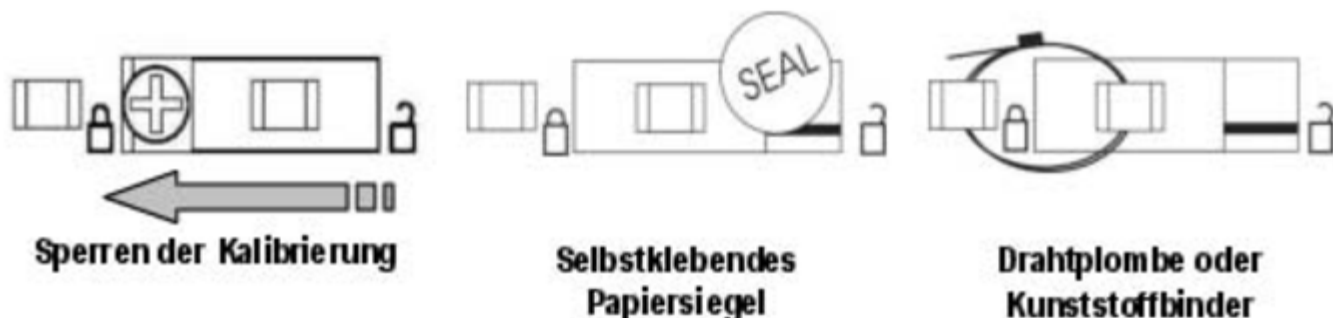
Abbildung 4-1. Sperren und Versiegeln des Kalibrierungssperrschalters
