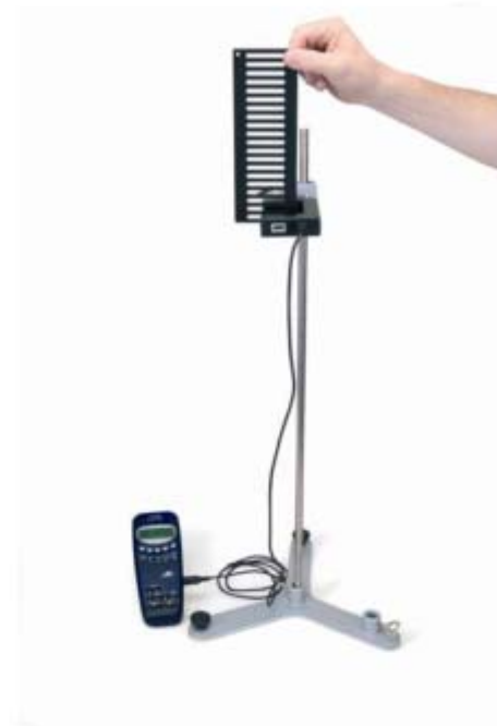
Fig. 1: Messung des Freien Falls
