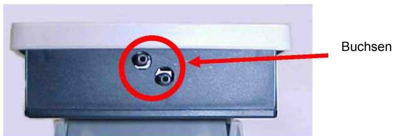
Der MOTOROLA-Drucksensor, befindet sich oben auf dem Gerät. Dort befinden sich 2 konischen Buchsen, die für den Anschluss des mitgelieferten Silikonschlauchs bestimmt sind (oder jedes anderen Schlauchs mit einem Durchmesser von 4 mm).
