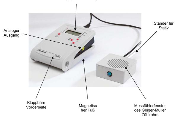
Einheiten: Anzeige in Impulse pro Sekunde (cps) oder in Anzahl von Impulsen (imp)
