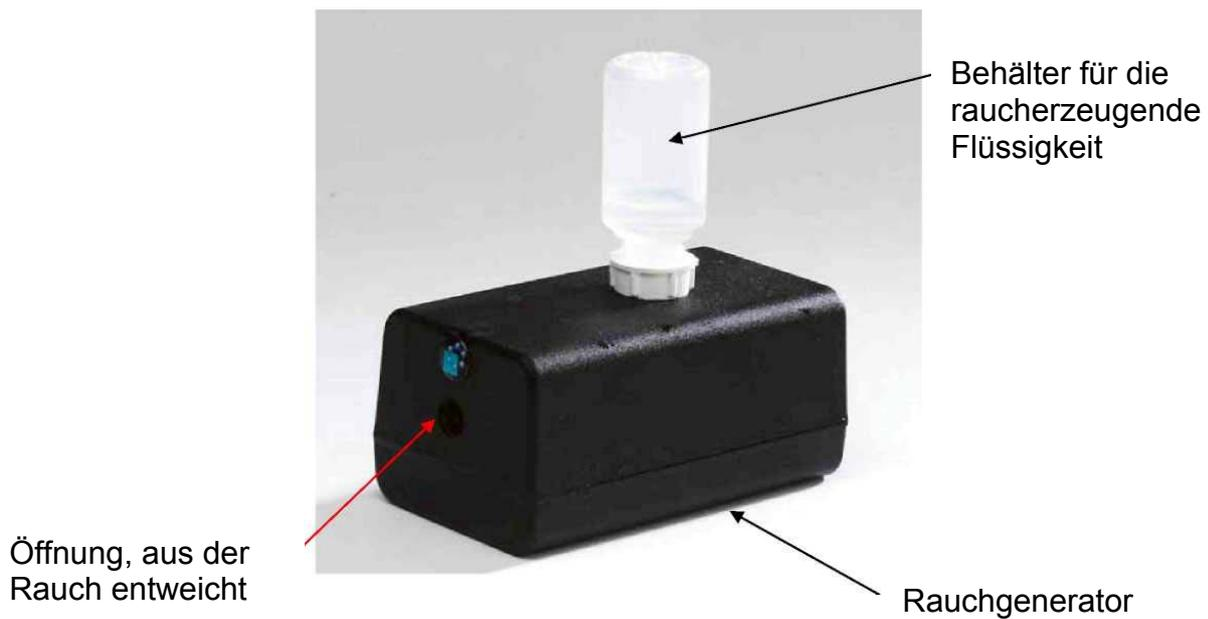
Dieses elektrische Gerät erzeugt unschädlichen Rauch. Ein Behälter mit einer raucherzeugenden Flüssigkeit befindet sich außerhalb des Gehäuses. Stromversorgung mit 4 mm Sicherheitsbuchsen, Gleichspannung 12 V. Ein Fläschchen mit 250 ml raucherzeugender Flüssigkeit wird mitgeliefert. Abmessungen: 130 x 75 x 65 mm
