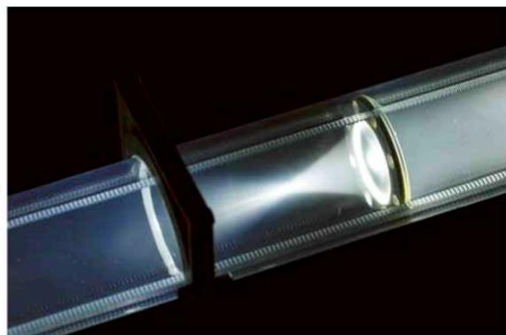
Verwendung des Rauchgenerators in Verbindung mit MODELOPTIC® und der MODELOPTIC®-Leuchte.
