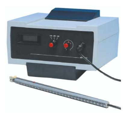
Das digitale Magnetfeldmessgerät ermöglicht eine direkte Messung magnetischer Felder, mit Feldstärken zwischen 0 und 100 mT.
