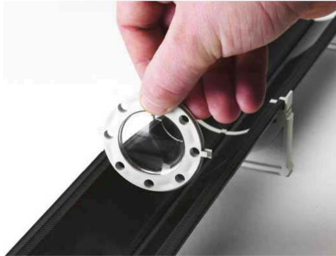
Setzen Sie die Stifte, die sich auf den beiden Seiten der Linsenhalterung befinden, in die dafür vorgesehenen Rillen (an den Rändern und am Boden der Halbschalen). Verwenden Sie die Skaleneinteilung an Nut und Feder der Halbschalen, damit beide Stifte sich exakt gegenüber stehen.
