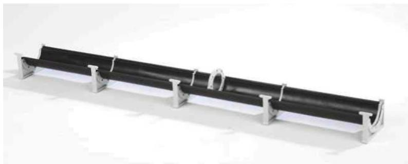
Wenn Sie die Leuchte MODELOPTIC MD03922, den Rauchgenerator MD03923 und die durchsichtigen Halbschalen MB03949 zusätzlich verwenden, verfügen Sie über ein Gerät zur Brennweitenmessung, bei der Sie den Weg der Lichtstrahlen auf einfache Weise visualisieren können.
