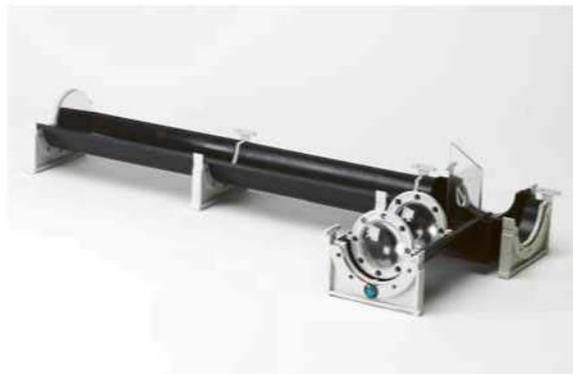
Fertig montiertes Teleskop
