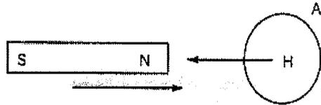
Nähert man den Magneten NS dem Stromkreis A, so steigt der Schub in A; der induzierte Strom  $i$  erzeugt ein Feld, das dem Feld  $H$  entgegengesetzt ist. Die Richtung wird von der „Korkenzieher-Regel“ bestimmt.
