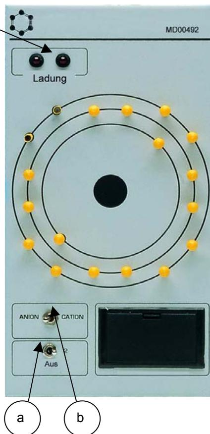
Der Elektronikkasten ermöglicht es den Schülern, sich über den Ladungszustand eines Ions, das sich aus einem Atom durch Aufnahme oder Abgabe eines Elektrons gebildet hat, zu informieren. In den Kasten sind zwei Schalter und zwei LED- Anzeigen eingebaut:
