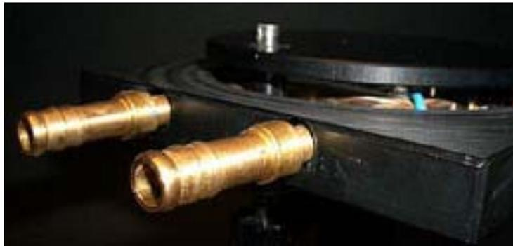
Abb. 7 Anschlüsse für den Kühlwasserkreislauf
