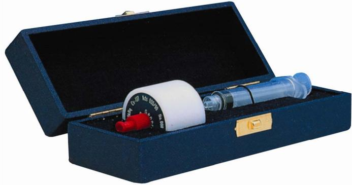
Mit ihm lassen sich wiederholt (bis zu 1000 mal) auf einfache Art und Weise kleine Mengen einer kurzlebigen radioaktiven Lösung herstellen. Die hierfür benötigte Elutionslösung gehört zum Lieferumfang (250 ml) und kann bei Bedarf nachbestellt werden.
