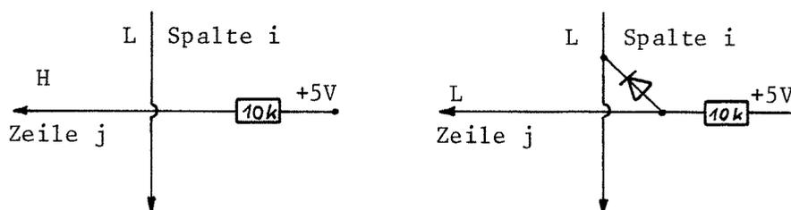
Ist an dem Kreuzungspunkt keine Diode, so liegt Zeile j immer über den Wider- stand auf High-Pegel, wenn die Spalte i aktiviert, d.h. Low ist.
