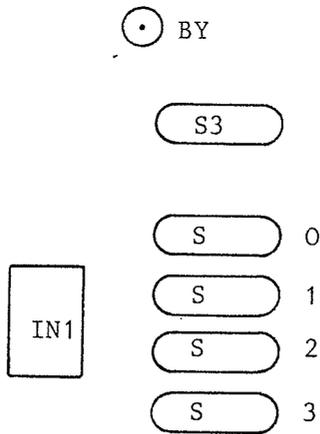
Die Information am IN1 Kanal ist durch die Stellung der vier Schalter festgelegt. Da Schalter speichernde Elemente sind, kann dieser Eingabekanal als Schalterregister betrachtet werden.
