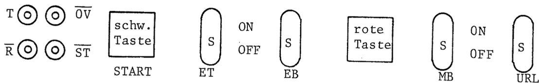
Die Start-Taste, der Einzeltakt-Schalter sowie der Einzelbefehl-Schalter beeinflussen nur die Arbeitsweise des Taktgenerators:
