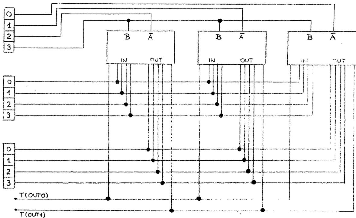
Wie eingezeichnet, müssen auch die beiden Registertakte T(OUT0) und T(OUT1) herausgeführt werden, um dem Gerät mitzuteilen, wann es Daten aufnehmen bzw. abgeben soll.
