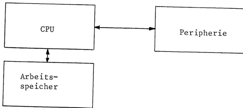
Unser Mikrocomputer besteht hier aus dem Arbeitsspeicher, dem Mikroprozessor, auch CPU (central processing unit) genannt und einer Ein- und Ausgabeperipherie. Auf der Platine des Modellrechners besteht der Arbeitsspeicher nur aus einem einzigen Baustein (RAM), der Rest gehört zur CPU. Um das Zusammenspiel dieser Teile zu verstehen, müssen wir nachsehen, wie die CPU mit dem Arbeitsspeicher zusammenarbeitet:
