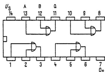
74125: Vier UND-Stufen mit je einem Eingang, Kontroll-eingang und Tri-State-Ausgängen
