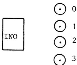
Beide Kanäle ermöglichen es, vom Programm her 4-Bit Daten mittels des INA Befehls in den Akkumulator zu laden. Über vier Buchsen kann Information von externen Geräten an den IN0 Kanal angelegt werden.
