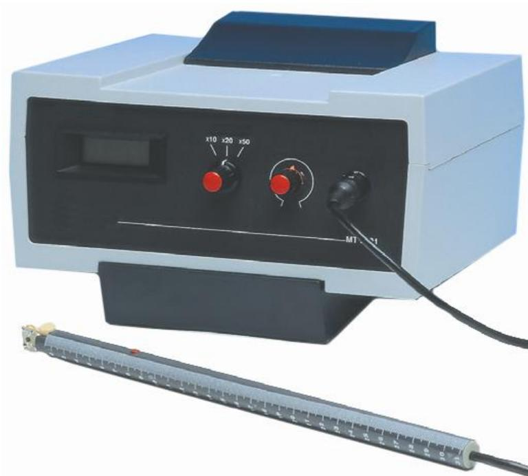
Das digitale Magnetfeldmessgerät ermöglicht eine direkte Messung magnetischer Felder, mit Feldstärken zwischen 0 und 100 mT.
