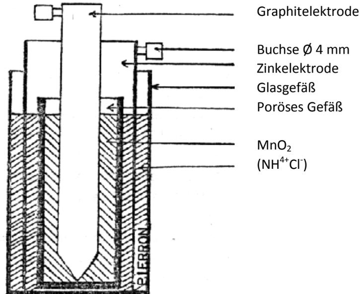
Bei diesem auch heute noch weit verbreiteten Primärelement tauchen ein Zinkstab und ein Kohlestab in einen Elektrolyten aus einer 10 - 20%-igen Salmiak-Lösung; der Kohlestab steht in einer Tonzelle oder einem Beutel. Zwischen Kohlestab und Tonzelle befindet sich fester Braunstein als Depolarisator, der den sich bildenden Wasserstoff (der sonst einen stromhemmenden Polarisations-Strom hervorrufen würde) zu Wasser oxidiert.
