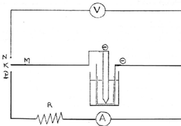
Indem Sie den Schalter K nach MN schließen, bringen wir ein Spannungsmessgerät zwischen die beiden Elektroden der Batterie. Wir können feststellen, dass ein Strom von circa 1,5 Volt fließt. Die elektromotorische Kraft E des Elementes liegt bei 1,5 V. Der Strom fließt von der Anode zur Kohlelektrode (Kathode). Durch diese Reaktion wird chemische Energie in elektrische Energie umgewandelt.
