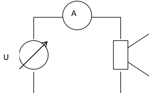
Schließen Sie die variable Spannungsquelle über das Vielfachmessgerät (Strombereich !) an den Lautsprecher an. Drehen Sie die Spannung zunächst auf Minimum (Linksanschlag)
