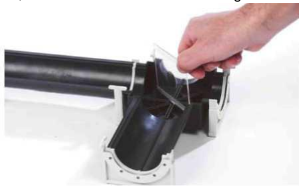
Einsetzen des Spiegels \varnothing 20 mm in 45^\circ Position der optischen Achse (verwenden Sie die Rillen am Boden des Teleskopteils)
