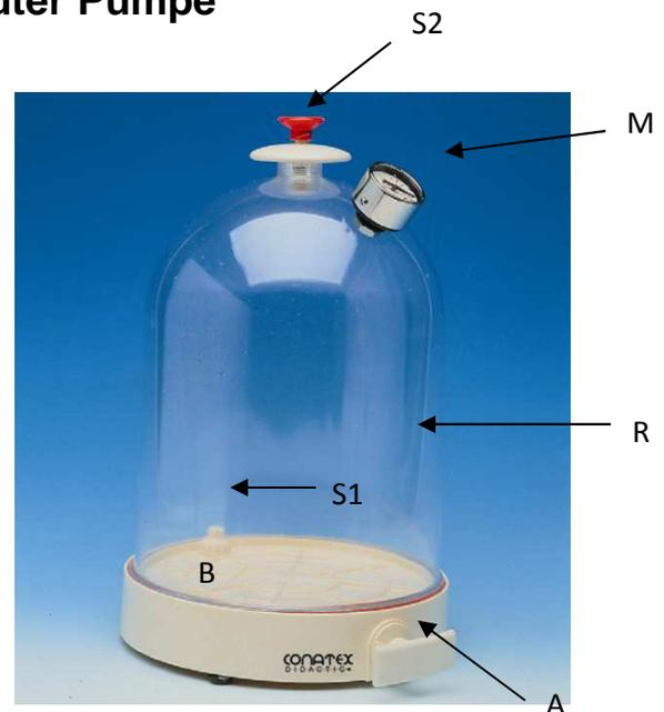
Dieser Rezipient besteht aus einer durchsichtigen, praktisch unzerbrechlichen Kunststoffglocke, einem integrierten Unterdruckmanometer und einem doppelten Belüftungsventil.
