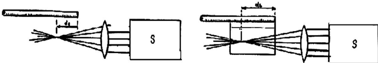
Man setzt die Lichtquelle auf die Metalltafel und stellt die Strahlen parallel ein. Dann bringt man die Küvette mit der Öffnung nach oben auf die Metalltafel derart an, dass die optische Achse parallel zu den Seiten der Küvette ist, und die Lichtstrahlen sie durchqueren. Jetzt bestimmt man den Brennpunkt. Danach füllt man die Küvette mit Wasser und befestigt den Maßstab oberhalb der Küvette parallel zur optischen Achse. Man liest  $D_1$  ab (Bild 1).
