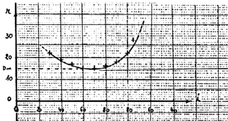
Berechnung von n bei minimaler Ablenkung
