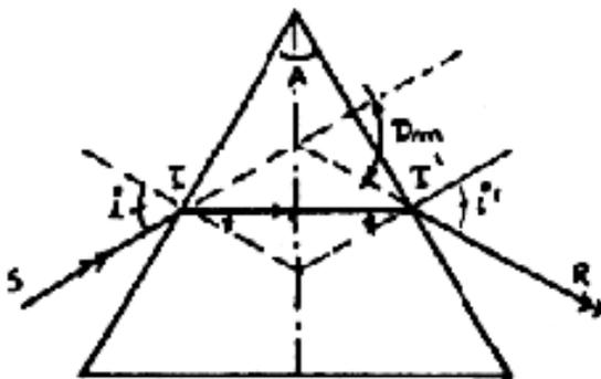
Bei symmetrischem Strahlengang, also  $i = i'$  und  $r = r'$  verläuft der Strahl im Prisma parallel zur Grundfläche, die Gesamtablenkung  $D$  erreicht ein Minimum. Mit dieser minimalen Abweichung  $D_m$ ,  $A$  (brechender Winkel des Prismas) und  $n$  (Brechungsindex) ergibt sich folgender Zusammenhang:
