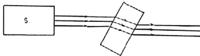
Man stellt eine planparallele Platte so auf, dass sie von den Lichtstrahlen der Lichtquelle 2002264 durchlaufen wird.
