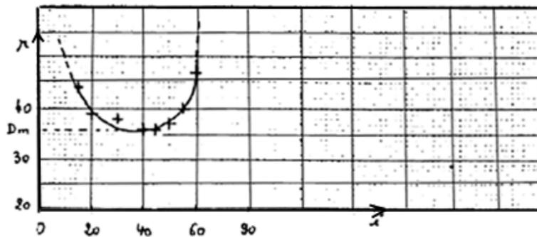
**Berechnung von n bei minimaler Ablenkung**
