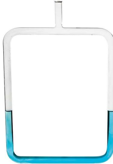
Dieses Borosilikat-Rohr ermöglicht die Untersuchung einer Konvektion durch Wärmeströmung - Nach Einfüllen von kaltem Wasser wird ein Schenkel des Rohres über eine Wärmequelle gehalten. Während der Erwärmung wird ein Färbemittel eingefüllt. Die Konvektion wird über die Vermischung sichtbar gemacht.
