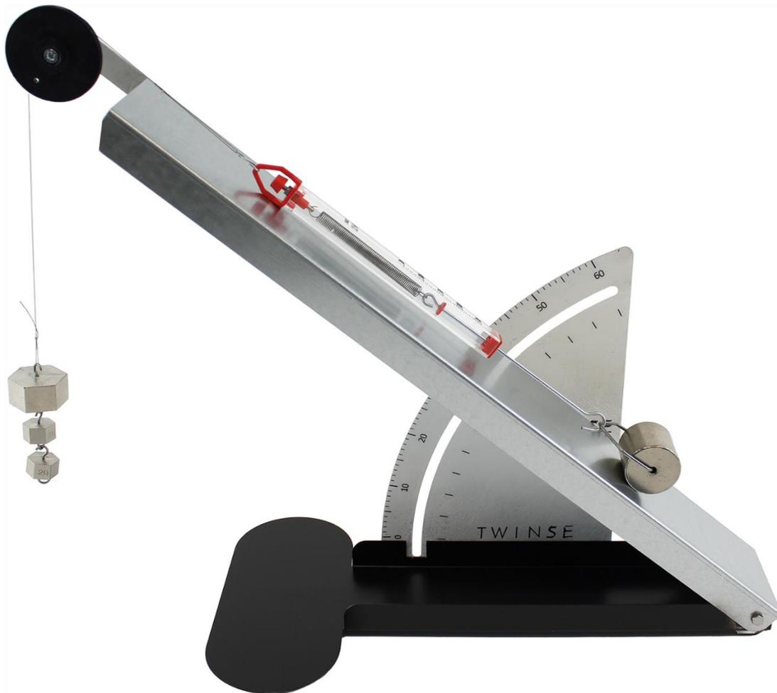
Eine *Schiefe Ebene* ist in der Mechanik eine gegen die Horizontale geneigte Fläche. Man verwendet sie, um eine Kraft, die man aufbringen muss um einen Höhenunterschied auszugleichen, zu verringern. Aber die Arbeit, die man dabei verrichten muss, bleibt gleich. Die *Schiefe Ebene* ist eine der einfachsten Maschinenkonstruktionen der Geschichte.
