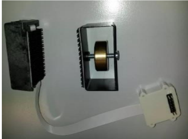
Abbildung 6: Vorrichtung für Druckspuren an der Außenseite eines Gleiters.
