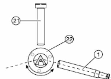
Drehen Sie nun das Teleskop bis der Spalt auf der anderen Seite des Prismas reflektiert wird. Lesen Sie wieder die Skala ab und notieren Sie den Wert. Die Differenz zwischen den beiden Werten ist der zweifache
