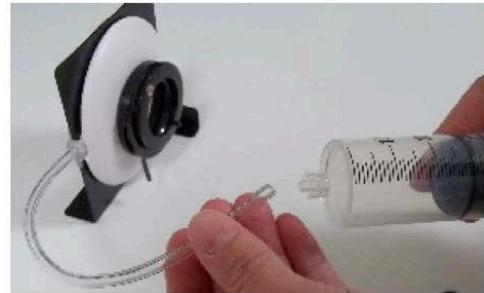
Führen Sie nun die Irisblenden-Linseneinheit in die vordere Aussparung des Grundkörpers ein. Platzieren Sie nun den Schirm auf der gegenüberliegenden hinteren Seite.
