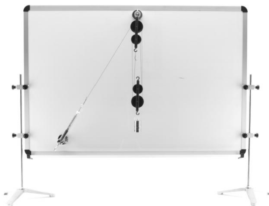
Aufbau mit 2-rolligen Flaschen
