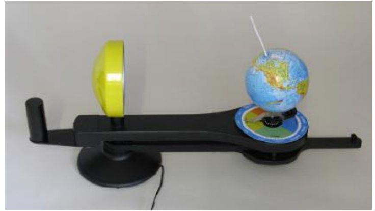
1: Tellurium mit großem Globus zur Demonstration des Jahreszeitenzyklus sowie von Tag und Nacht.
