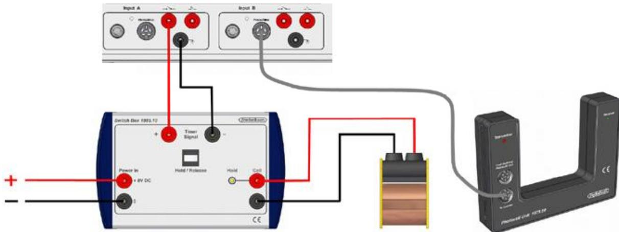
Das Ausgangssignal **Timer Signal** wird an den Starteingang des Timers angeschlossen. Ist die Spule bestromt, ist das Ausgangssignal etwa 0 V (*low*). Wird die Spule Stromlos, steigt das Ausgangssignal auf 8-10 V (*high*).
