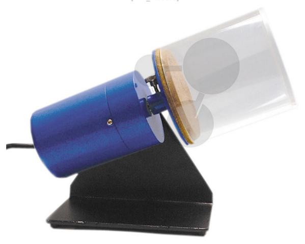
Klinostat Apparat mit Zylinderaufsatz
