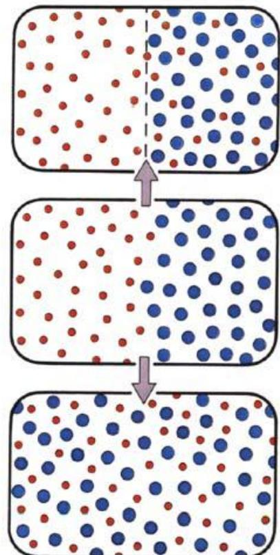
Modell eines osmotischen Systems: Zwei Behälter sind durch eine semipermeable (selektiv durchlässige) Membran getrennt. Die Porengröße ist ausreichend, um kleinen Partikeln (Ionen, Molekülen) einen ungehinderten Durchlass zu gewähren; sie verhindert den Durchgang der großen. Es baut sich daher im linken Behälter ein höherer osmotischer Druck auf, da sich
