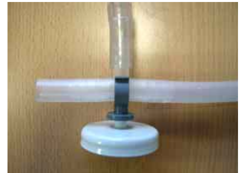
Abb. 2: Die Schlauchenden ganz aufziehen, dann die Röhre in den Halter stecken
