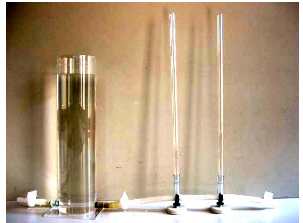
Abb. 6: zwei Steigröhren sind angeschlossen
