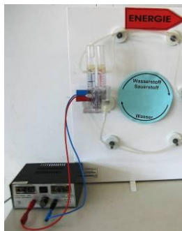
Abb. 3: Antrieb des chemischen Energie-Träger-Stromkreise mithilfe eine Netzgeräts, eines Handgenerators, einer Solarzelle
