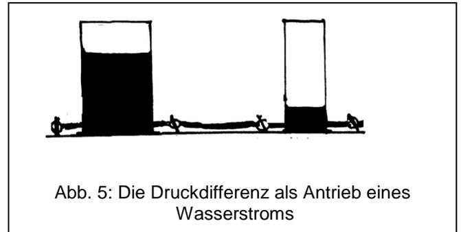
Abb. 5: Die Druckdifferenz als Antrieb eines Wasserstroms
