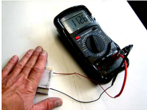
Abb. 14: Die angezeigte Spannung ist umso größer, je größer die Stärke des Entropiestroms ist, der durch das Peltierelement hindurchfließt.
