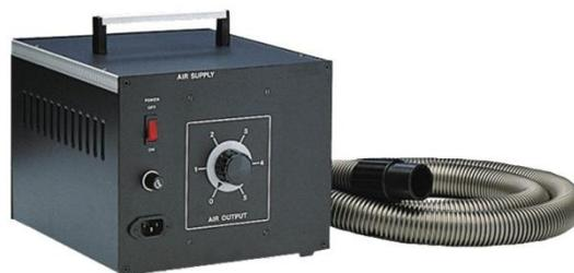
Dieses Gebläse ist stufenlos im Luftstrom einstellbar und ist schallisoliert. Es ist mit einer thermischen Überlastsicherung ausgestattet. Der Betrieb erfolgt mit 230 V / AC. Die Masse des Gebläses ist 5,7 kg. Die Schlauchlänge beträgt 1,7 m.
