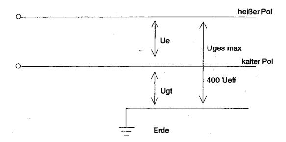
$U_{\text{ges}}$  Gesamtspannung (Effektivwert) zwischen heißem Pol und Erde
