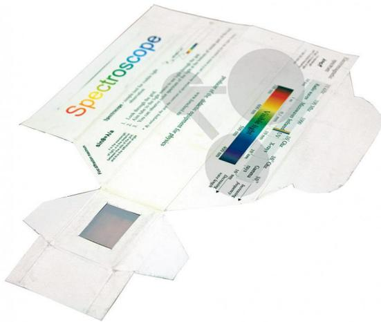
Spectroscopes économiques pliables à monter soi-même
